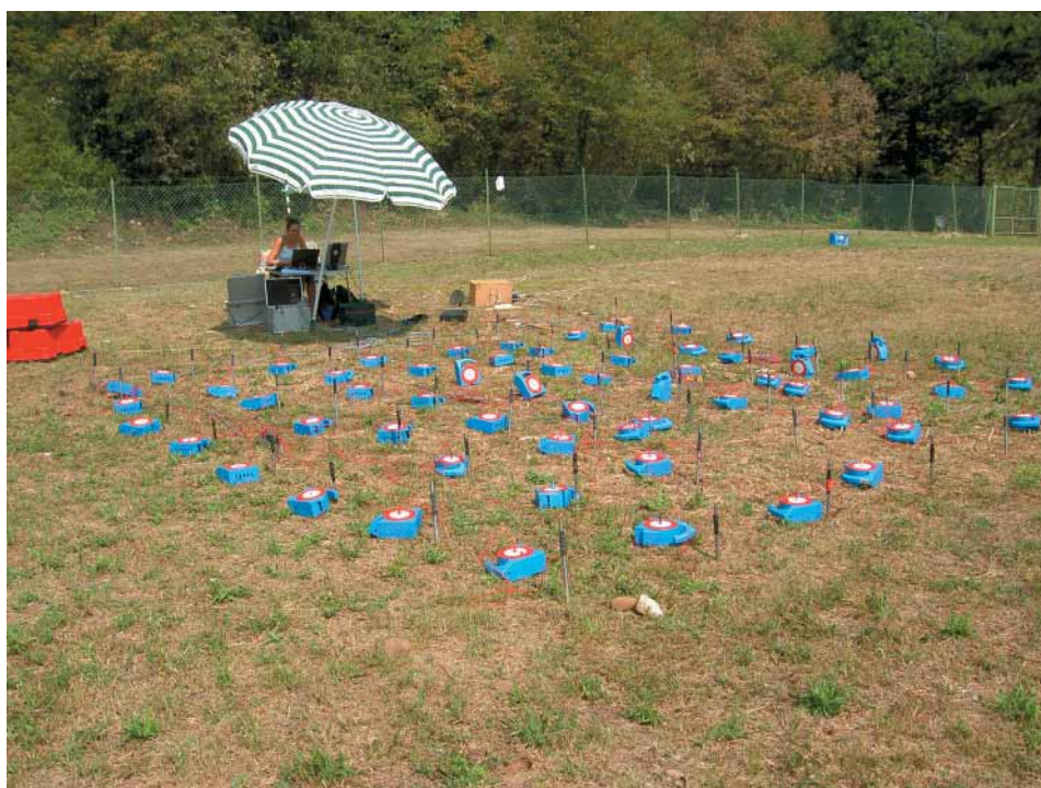
Fig. 3 - Esempio di allestimento di indagine elettrica in situ.
