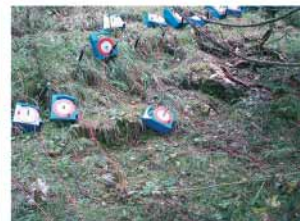
Prolunghe per la connessione degli elettrodi con ERS.
