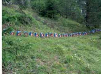
Particolare dell'allestimento di indagine: due stendimenti multi-elettrodo paralleli, il primo predisposto per la misura.
