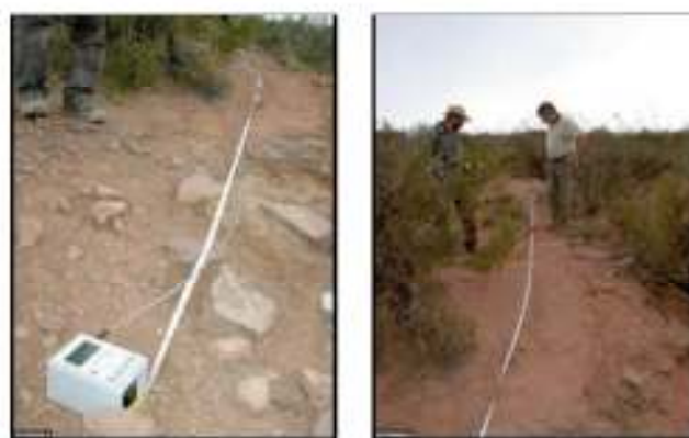
Fig. 7 – a) b) Tromógrafo unido a sensor trigger para realizar una adquisición de sísmica activa en ondas superficiales.
